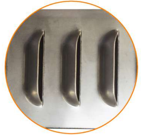
Embutición y corte para elementos de ventilación
